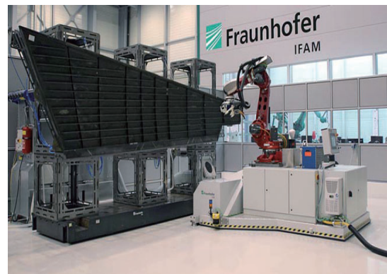
图5 可移动机器人系统正在进行A320飞机复合材料垂尾翼面加工 Fig.5 Mobile robot system machining a shell of an A320 vertical tail plane
