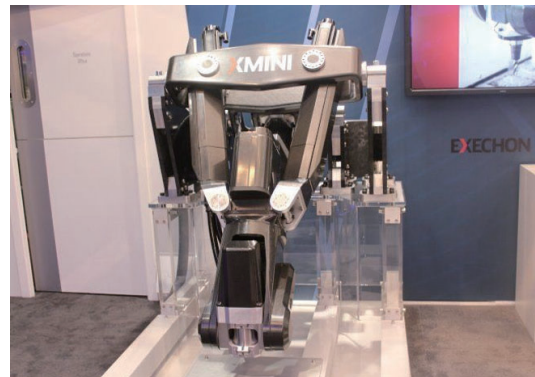
图4 XMini混联加工机器人 Fig.4 Xmini hybrid processing robot
